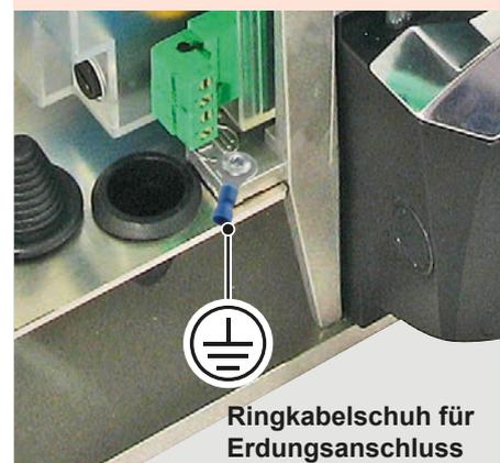
Ringkabelschuh für Erdungsanschluss
