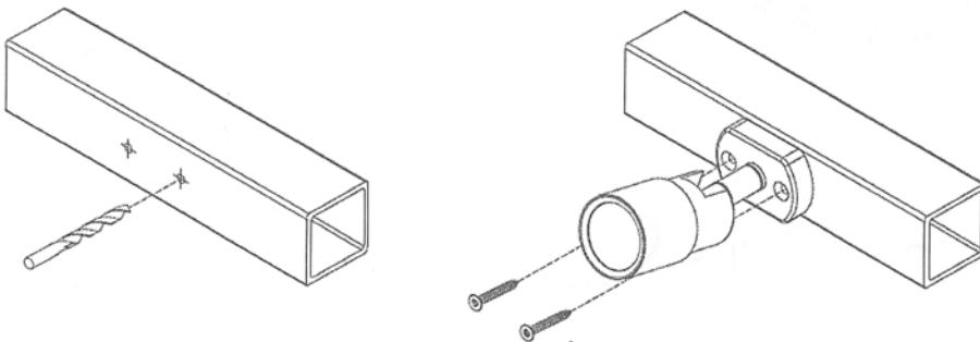
Befestigen Sie das Produkt mit den gelieferten Schrauben.
